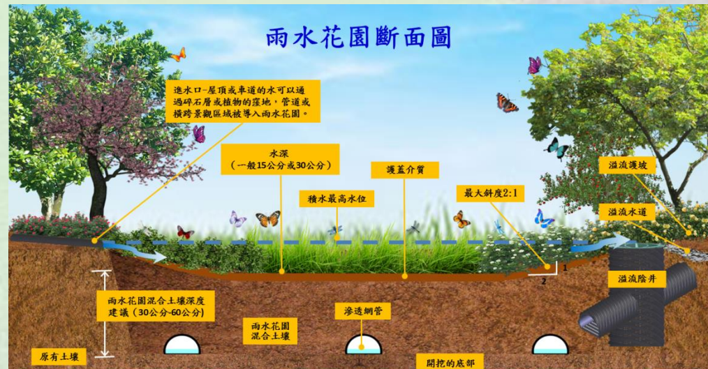
圖3-13 花園土壤雨水截留構造示意圖
