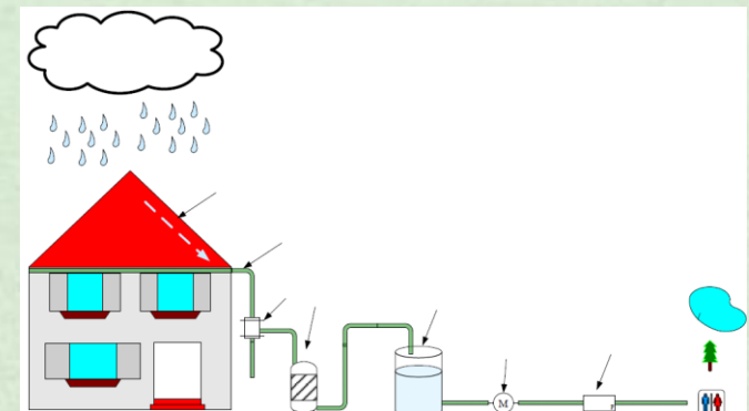
圖3-30 雨水貯集利用系統組成
