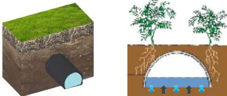
AMP-滲透網管排除土層中飽和的水，網管不阻塞，生態工法施工，是最佳地下的集透排水資材。
