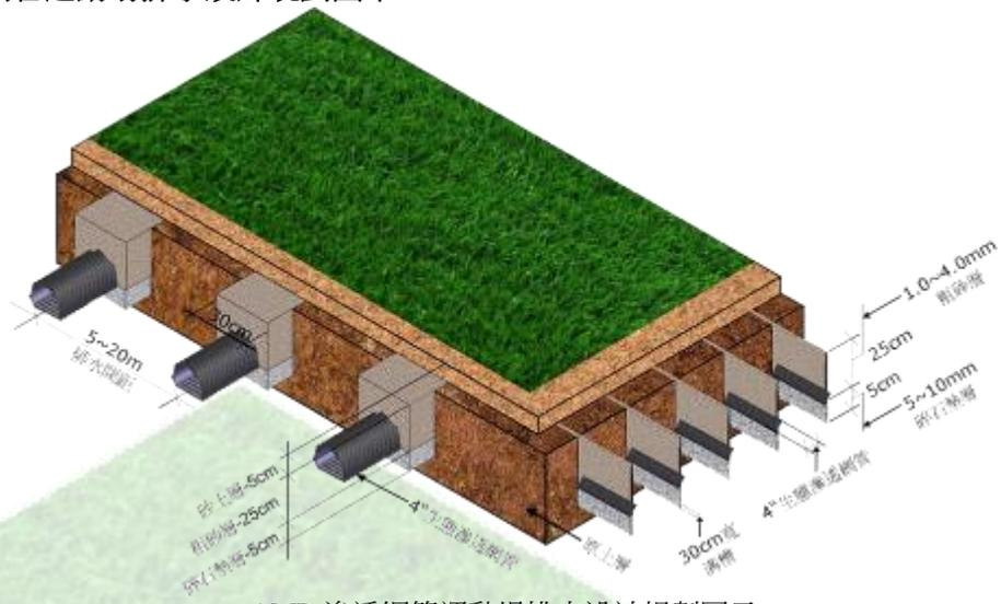
AMP-滲透網管運動場排水設計規劃圖示
